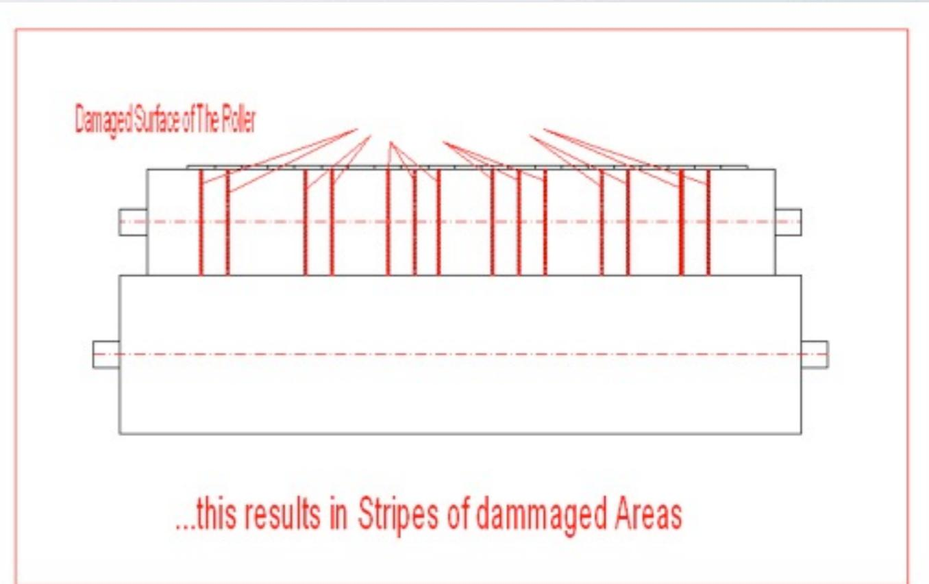
**PHYSICAL ABRASION OF METAL APPLICATORS CAN WEAR THE SURFACE OF THE IMPRESSION ROLLER WHICH CAN SHORTEN THE LIFE OF THE IMPRESSION ROLL AND EFFECT THE PRINT QUALITY**
